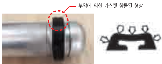
부압 10inHg(절대값)에서의 고무 가스켓 형상변화 상태
