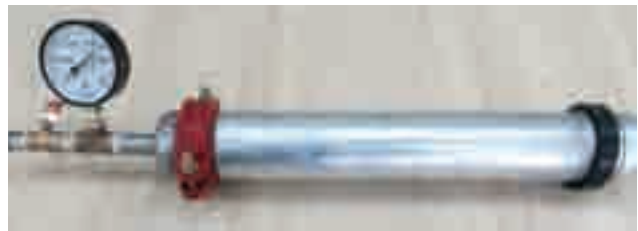
진공펌프 부압 테스트 장치
